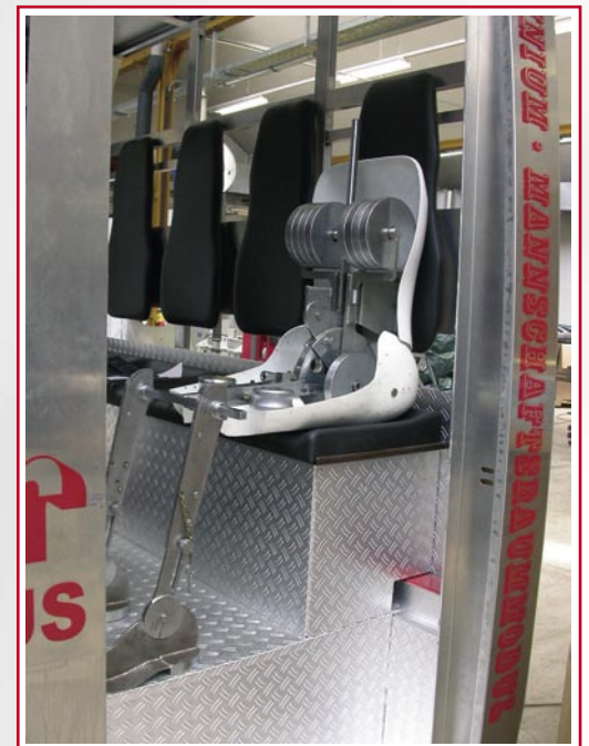
Überprüfung der Gurtverankerungspunkte nach den Gesetzesanforderungen der ECE-R14 durch den TÜV
